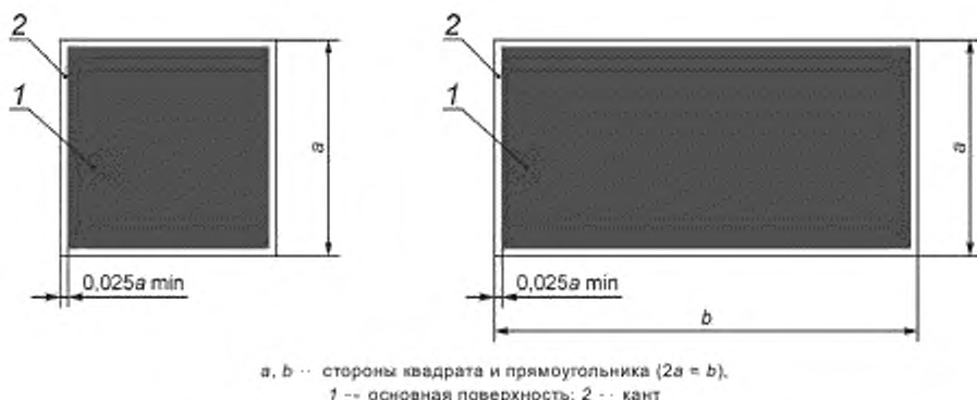
Рисунок 5 — Основа цветографического изображения и соотношение размеров эвакуационных знаков безопасности и знаков безопасности медицинского и санитарного назначения
