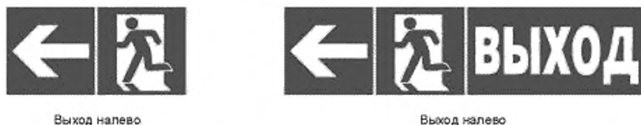
Рисунок 10, лист 1 — Примеры формирования смысловой комбинации знаков для указания направления движения к эвакуационному выходу, средствам противопожарной защиты, месту сбора и средствам оказания первой медицинской помощи
