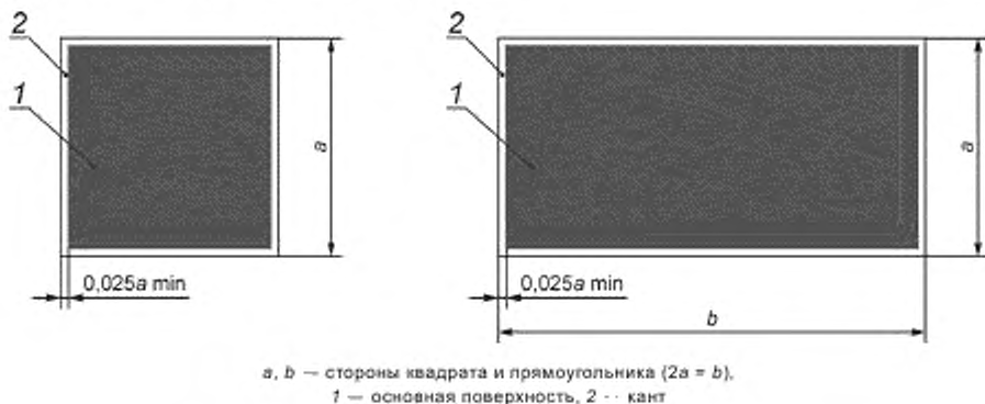
Рисунок 6 — Основа цветографического изображения и соотношение размеров указательных знаков безопасности
